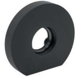
Bシリーズレンズマウントバレルは、単レンズやアクロマティックダブルレットレンズ、シリンドリカルレンズなどを保持して傷が付かないように保護する目的で使用します。これらのバレルをSBまたはCBシリーズのレンズバレルホルダにマウントすることにより光学システムの一部として組込むことが可能になります。レンズバレルはネジが切られた本体とリテーニングリングから構成され、リテーニングリングをねじ込むことによってレンズが所定の位置にしっかりと固定されます。
