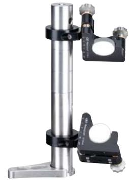
ベDESTALポストに延長ポストを取り付け、スライド式クランプとミラーマウントを追加することでビームステアラーを構築できます。
