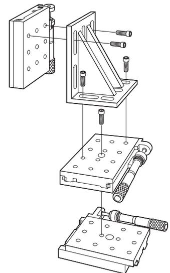
モデル360-90と360-30を直進ステージモデル423、433、426、436などと組み合わせることにより、可動範囲の大きなXYZステージを作ることができます。
