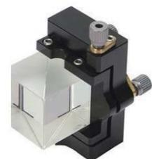
回折格子だけでなく、1インチ、2インチのビームスプリッターキューブとアングラプリズム、矩形ミラーも取り付け可能
