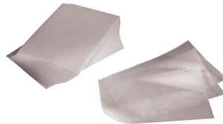
きわめて柔らかく、薄く、そして傷を与えないこのティッシュは、コーティングのある光学部品を清掃するのに最適です。米国政府のレンズペーパー規格AA-50177、Type 1、Class 1に適合しています。ドロップアンドドラッグ清掃法に最適です。
