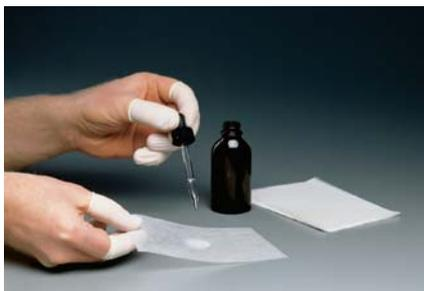
清潔な作業台に光学部品を置きます。ブローで異物を吹き払います。1組のティッシュを折らずに光学部品の上方に持ち上げておいてから、そのティッシュにアセトンを数滴垂らします。レンズティッシュを下げて光学部品にかぶせたら、光学部品の全面をなでるように引っ張ります。光学部品がきれいになるまでこの工程を繰り返します。必ず、引っ張り終えるごとに新しいレンズティッシュを使用してください。そうすることにより、はがれた汚れを引きずって光学面を傷つけることを防げます。
