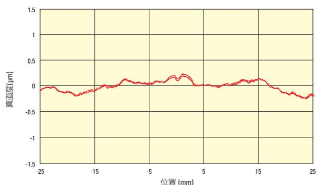
XMステージは、多くの精密スキャンやウェーハ検査プロセスで要求されるリップルのないモーションを実現します。ここに示したデータは、XMS50ステージの1サイクルの前進/後進で干渉計により測定。
