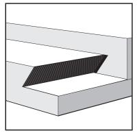
アリ機構スライドは、あらゆる動きの中で最も 単純な動きです。相互にスライドする精密研磨 仕上げの2つの平面で構成されます。
