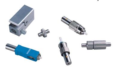
F-ASおよびF-AMベアファイバ用アダプタは、シングルモードおよびマルチモードのファイバの一時的な接続が素早くかつ簡単に行えるものです。本アダプタは、ファイバをパワーメータ、OTDR、さらに、他の様々な機器に接続する際に非常に便利なもので、取り外すことができないコネクタを装着しなくても、その場で機能試験が行えるものです。
