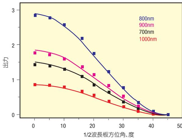
スペクトラ・フィジックス製Mai Tai超高速発振器のさまざまな波長での計算(実線)と測定による減衰曲線
