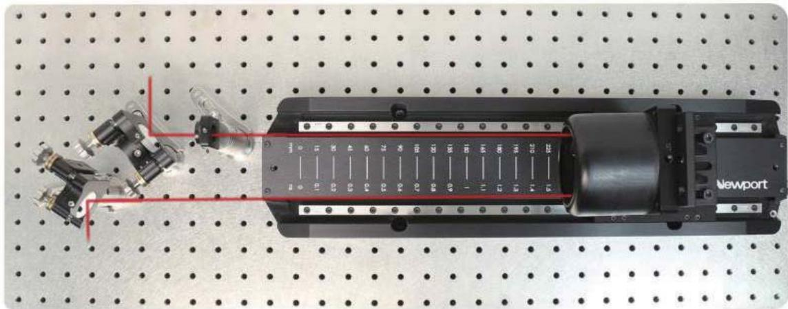
ディレイライン(1,2,4光路)を構築するためのオプティクス類と光学部品セットです。高精度のDLシリーズリニアステージを購入することで、再現性の高いポジショニングを制御することができます。
