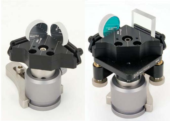
ガイドに沿ってミラーを挟むだけで簡単に柔軟にディレイラインを構築できます。
