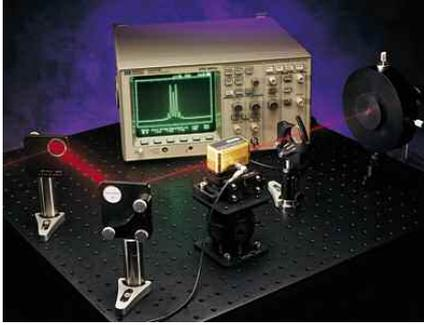
位相変調測定のためのセットアップ例。駆動周波数29MHzのModel 4001共振型位相変調器を透過したHeNeレーザービームを光スペクトラムアナライザへ集光します。特徴的な周波数サイドバンドを伴うレーザーの位相変調スペクトルをオシロスコープで確認できます。
