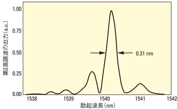
この位相整合曲線は、New Focus™の波長1540 nmのレーザーを使用して、周期分極されたLiNbO<sub>3</sub>導波路ダブラーで生成しました<sup>3</sup>。
