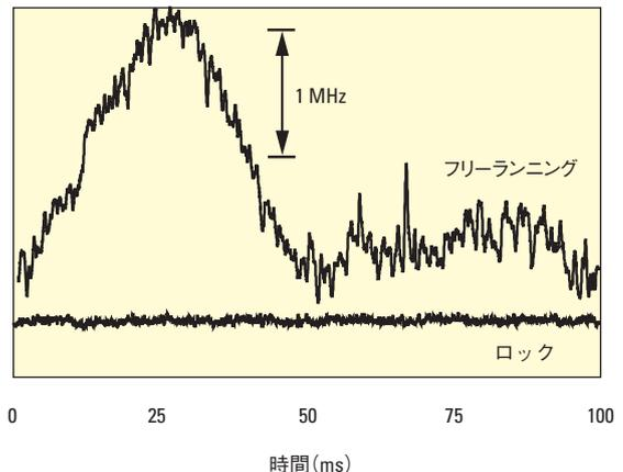
このグラフは、New Focus™レーザーでフィードバック制御を行わない場合の周波数ノイズと、同一のレーザーでルビジウムのサブドブラー吸収線まで積極的に安定化したときの周波数ノイズを比較しています。<sup>2</sup>
