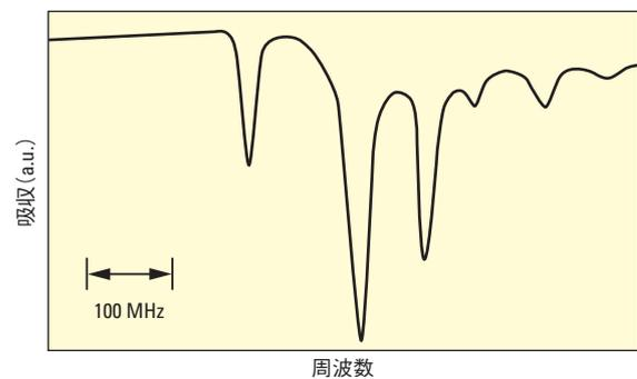
このグラフは、TLB-6800レーザーおよびNirvana自動平衡受光器から取得した、ドップラー効果のないルビジウム吸収線を示しています。
