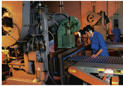
Newportのスタンピング機械で、特注ハニカム構造を製造できます
