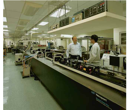
Newportのテーブルシステムは、振動に敏感な多数の研究用および生産装置の相対運動を最小に抑えます。
