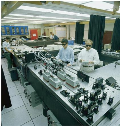
カリフォルニア大学（カリフォルニア州サンディエゴ）の高エネルギーレーザーシステムの建設中におけるモジュール式テーブルシステム。4×4フィートのモジュール17台と2×4フィートのモジュール3台、そして28台の空圧ダンパーで構成されます。
