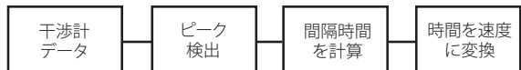
図11:平均チューニング速度を決定する方法を示すブロック図。
