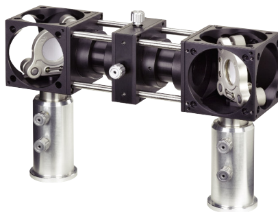
Q-RGシリーズのガイドロッドを使用すれば、Q-XILP-1レンズポジショナを2つのキューブの中間に配置することができます。
