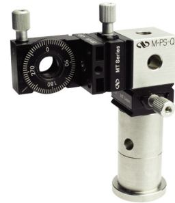
PS-QペDESTALキューブを使用しているMTステージアセンブリ。MT-RS偏光子ローテータは、取り外したMT-AB2アダプタプレートのいずれかを使用するだけで、MT-Xステージに直接マウントできます。
