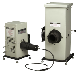
リサーチアークランプハウジングの出射光に取り付けたファイババンドル
