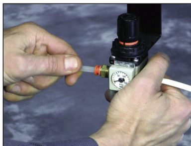
最後に、一体型レベル調整脚と気泡管水準器を使用してフレームのレベルを調整し、実装済みのARFIに空気供給のためのプラグを接続します。
